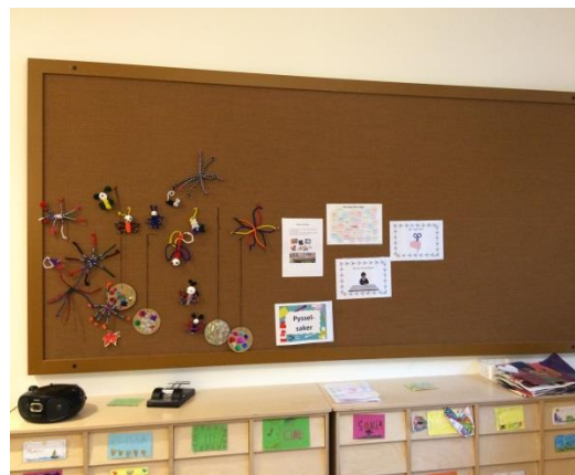
En anslagstavla ger både funktion och akustikdämpande egenskaper
